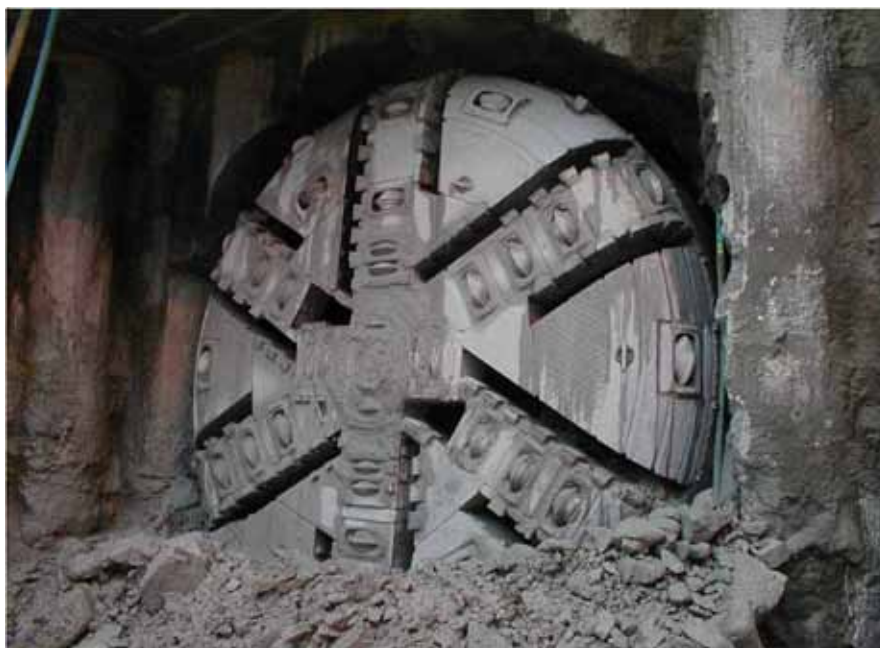
Figur 4.6 Frontskjoldet på en tunnelboremaskine.
