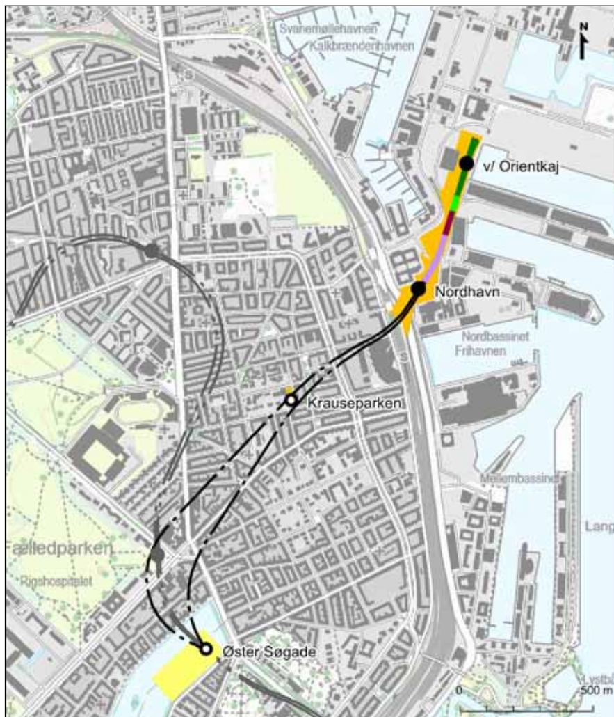
Figur 2.1 Principskitse for Nordhavnsmetroen – linjeføring, stationer og sammenhængen med Cityringen.
